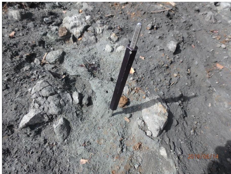
Figura 3.14 Ensayo con penetrómetro manual en depósito de brecha de deslizamiento gris verdosa en la margen derecha de la quebrada Paraíso Central. Coordenadas 596853.68E - 979333.8783N.
