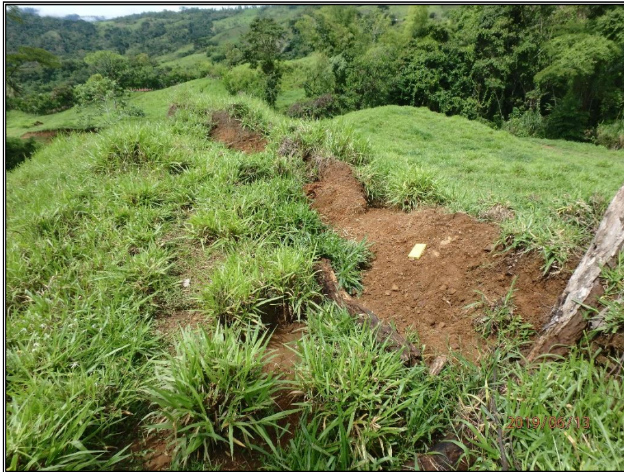
Fotografía A.1.3 Continuación de la grieta que representa el límite superior del deslizamiento activo. Coordenadas 597001.50E - 979157.51N.
