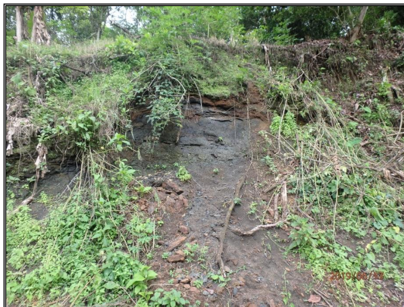
Figura 3.5 Afloramiento local de areniscas medias ligera a moderadamente meteorizadas de color gris verdoso. Se observa al borde del camino hacia Paraíso, el afloramiento parece in situ aunque es muy pequeño para confirmarlo. Coordenadas 596764.53E - 978903.38N.
