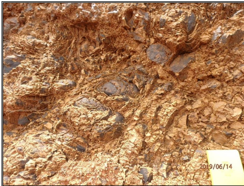
Figura 3.4 Afloramiento local de areniscas medias fuertemente meteorizadas, meteorización esferoidal, de color café. Se observa al borde del camino al norte de la comunidad de Paraíso. - Fila Angusiana - anfiteatro del deslizamiento. Coordenadas 595328.16E - 977122.7290N.
