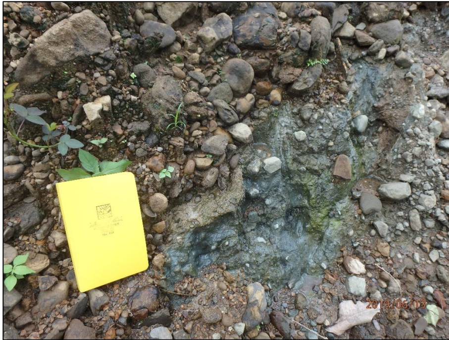
Figura 3.15 Brecha de deslizamiento gris azulada quebrada Paraíso - puente superior, cerca de la comunidad de Paraíso. Coordenadas 595807.09E - 978622.92N.
