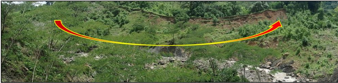
Fotografía A.1.23 Panorámica de la desembocadura de la quebrada Paraíso, las laderas inestables presentan una rotación y un levantamiento de la superficie hacia aguas arriba. Coordenadas 598546.58E - 979189.61N. Posiblemente corresponde con un plano de deslizamiento circular profundo.
