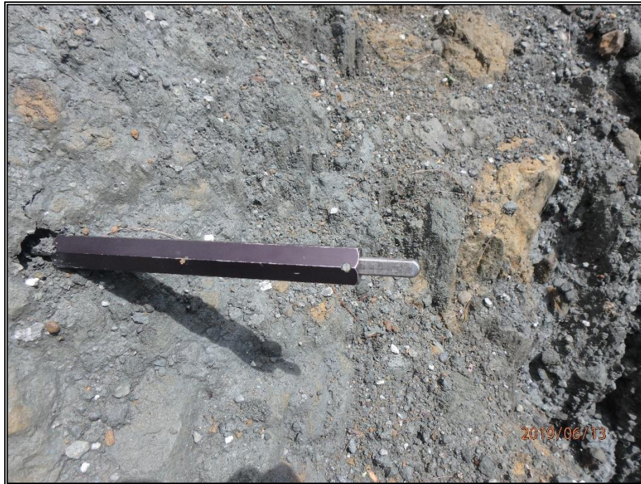
Figura 3.17 Ensayo de penetrómetro manual en material deslizado con granulometría limo arenoso y grava, resistencia de 1,5 \text{ kg/cm}^2 (desembocadura quebrada Paraíso). Coordenadas 598604.28E - 979144.19N.
