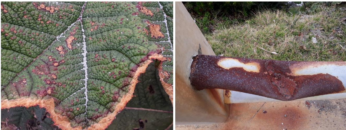
Fig. 43. Efecto de la lluvia ácida del Poás sobre la vegetación y los metales con hierro.
