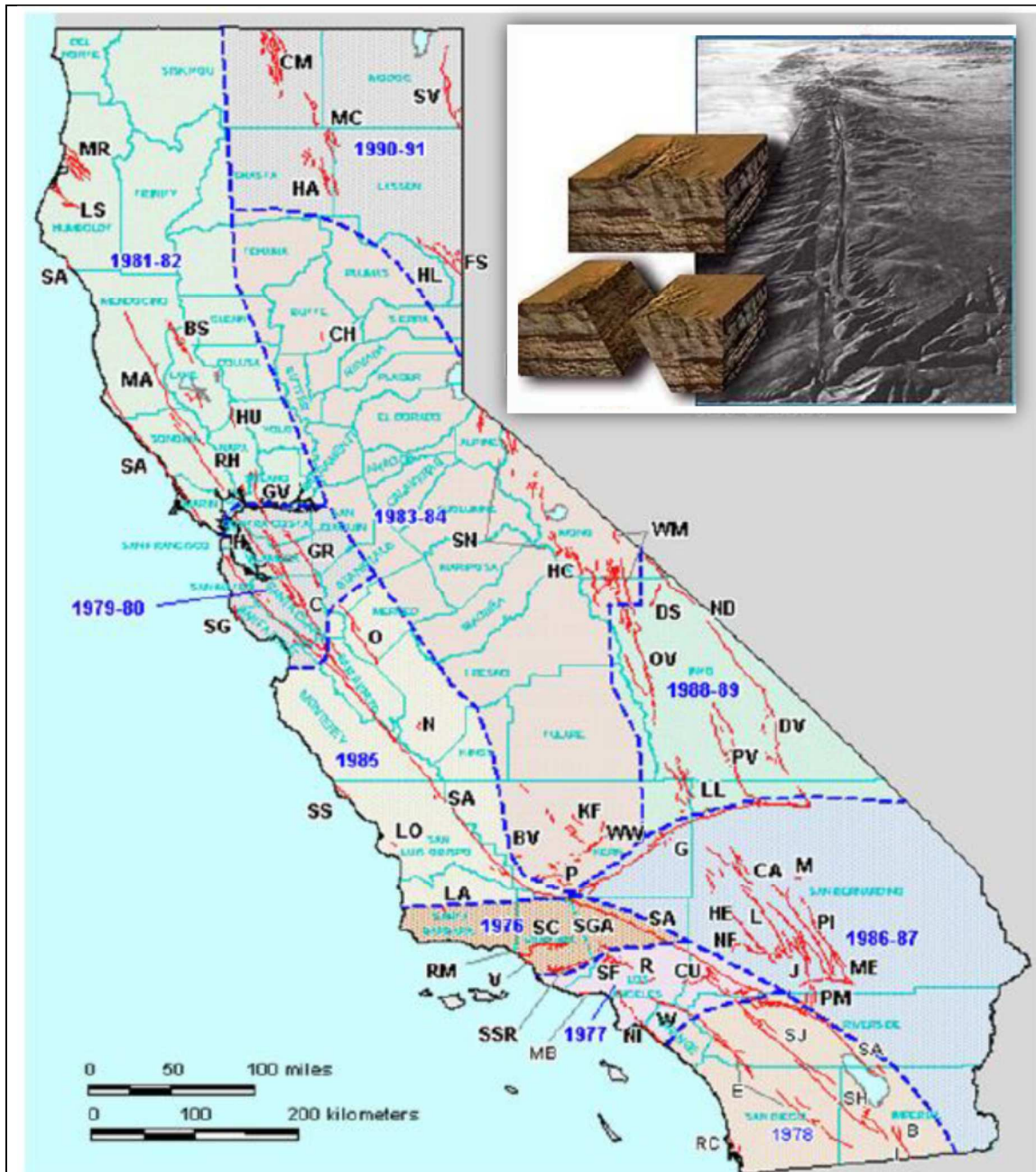
Fig. 2.2. Mapa de fallas geológicas activas (trazas rojas) identificadas en el Estado de California con el uso del Protocolo "Alquist - Priolo" (cf. Bryant & Hart, 2007).
