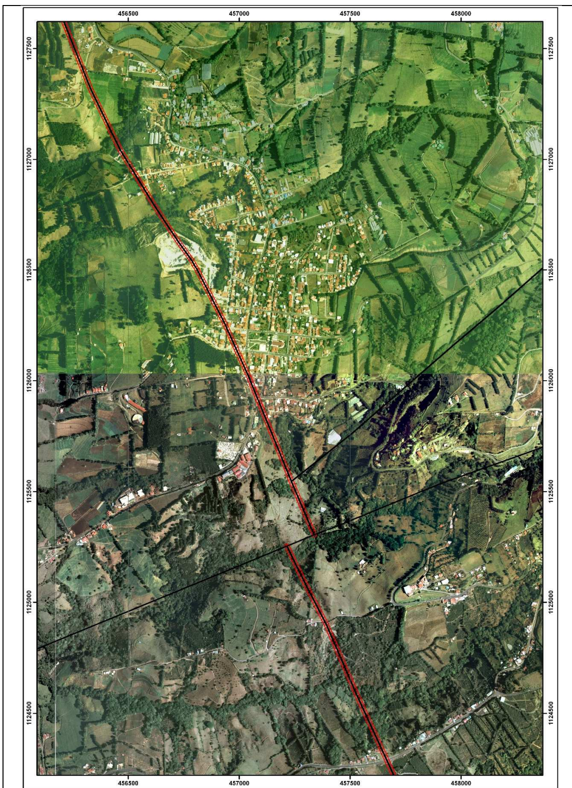
Fig. 5.28. Localización de la traza de la Falla Zarcero y de la zona de seguridad de 10 metros sobre las ortofotos del programa de Regularización y Catastro.
