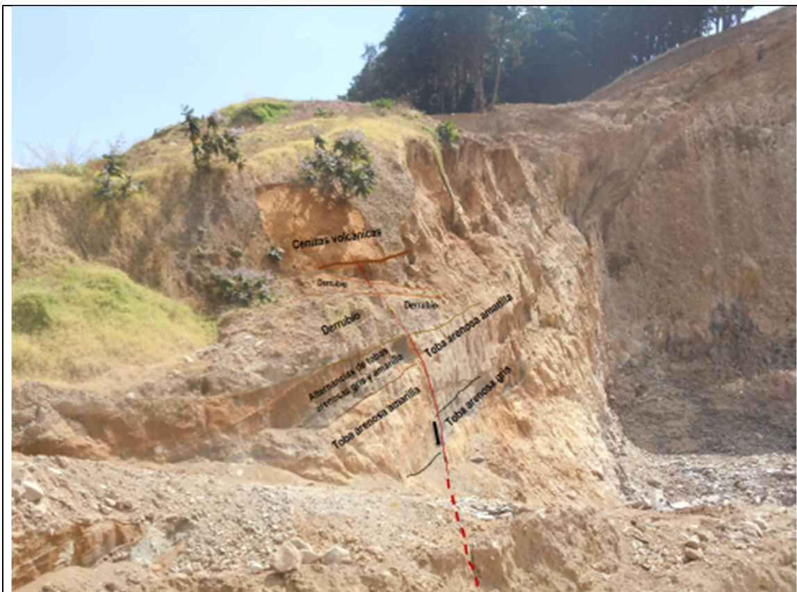
Fig. 5.25. Interpretación del afloramiento del tajo donde aparece la Falla Zarcero, una vez que se ha limpiado la sección superior (ver Figura 5.23). Se observa con claridad que la falla NO AFECTA la capa de cenizas volcánicas subrecientes, tal y como se observó en las trincheras y otros afloramientos del área de estudio.
